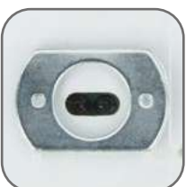
Оптопорт для снятия данных и программирования счетчика
