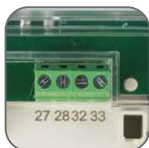
RS485 порт для программирования и применения в АСКУЭ
