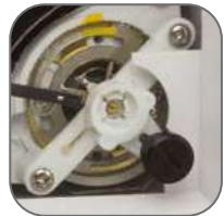
Настройка нулевого положения стрелки
